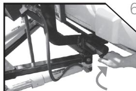
6. Tire de la manija en el lado del conductor para desenganchar los pasadores, luego gire hasta que la ranura bloquee los pasadores en la posición abierta.
