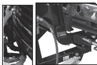
6. Mientras empuja levemente el bastidor de elevación hacia el vehículo, tire de la manija en cualquiera de los dos lados para desenganchar los pasadores, luego gire hasta que la pata bloquee los pasadores en la posición abierta.
