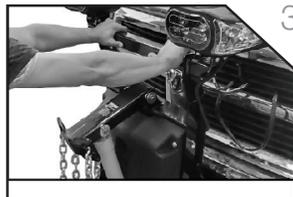
3. Empuje hacia atrás el bastidor de elevación hasta que los pasadores entren en el soporte del vehículo.
