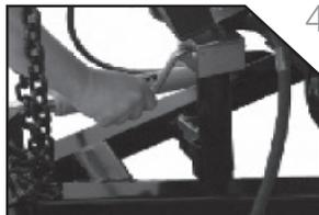
4. Ajuste el gato hasta que deje de estar en contacto con el suelo.
