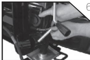
6. Fije el gato al bastidor de elevación.
