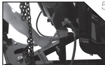
5. Ajuste el gato hasta que entre en contacto con el suelo, luego gire 1 a 2 revoluciones.
