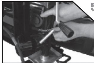
5. Fije el gato al bastidor de elevación.
