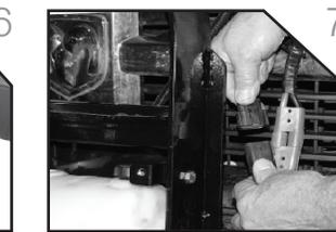
7. Desconecte los dos enchufes eléctricos y coloque tapas protectoras en ambos extremos.
